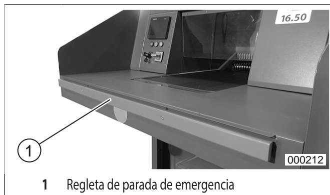
fig.3 Regleta de parada de emergencia
