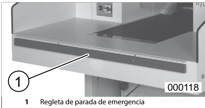
fig. 7 Regleta de parada de emergencia
